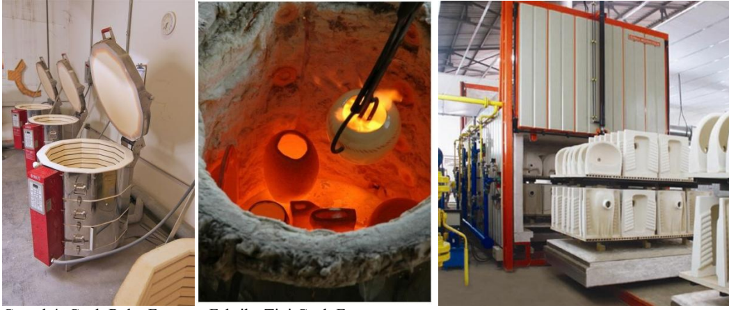
Görsel 4: Gazlı Raku Fırını ve Fabrika Tipi Gazlı Fırın.
