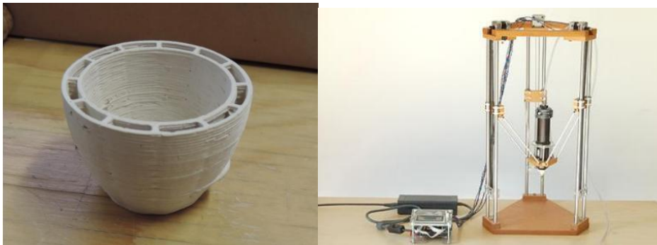
Görsel 13: FDM yöntemiyle üretilmiş ilk seramik form, 8x7x7 cm, 2009.
